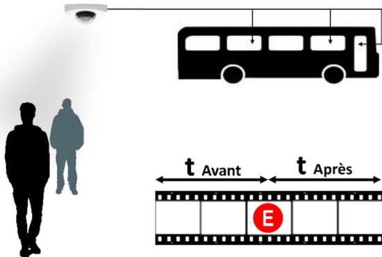
La solution SEIPRA Score permet de stocker 1 To de séquences vidéo durant 30 jours maximum. Ces séquences peuvent être sauvegardées par le conducteur à l'aide d'un bouton d'alarme lors d'un évènement particulier.
